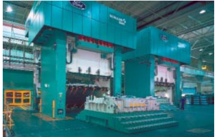
Presse zur Einarbeitung von Werkzeugen für die Produktionspressen mit ausgefahrenem Fahrtisch.
