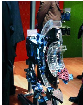
Modell eines Bremsscheibensystems für Schienenfahrzeuge. Modèle d'un système de disques de freins pour véhicules sur rails.
