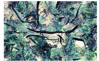
Bild 1: Gefüge von Gusseisen mit Lamellengraphit im Schliffbild.
