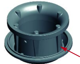
Bild 7: Unterhalb der Speiser wurde die Wanddicke lokal erhöht.
