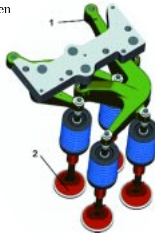
Bild 1: Funktionsprinzip der Kipphebel im MAN B&W Dieselmotor 48/60B (freie Formgebung ermöglicht ein Minimum an bewegten Teilen).
