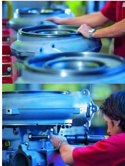
Gegossene Turbinengehäuse nach erfolgter mechanischer Bearbeitung und bei der Montage.
