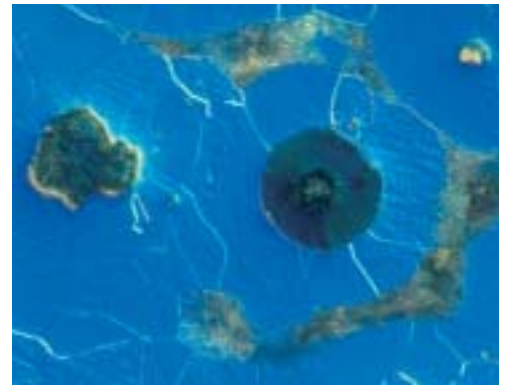
Gusseisen mit Kugelgraphit im polarisierten Licht: Graphitkugel (schwarz) in ferritischem Grundgefüge (blau) mit perlitischen Phasen (braun)
