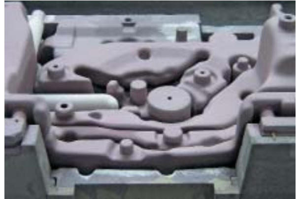
Kernpaket eines komplexen Gussteils – total 10 Kerne mit einem Gewicht von 175 kg bei einem Gussteil-Gewicht von 180 kg
