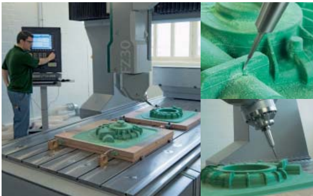
5-Achsen-Portalfräsmaschine in Aktion Fraiseuse à portique à 5 axes en action
