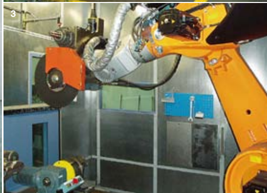
1 Notre seconde fraiseuse CNC à portique FZ30 durant la mise en service. 2 Machine robotisée d'ébarbage et tronçonnage Robo-Mill de l'entreprise LIEBER GmbH. 3 Robot industriel avec meule tronçonneuse et broche porte-fraise haute fréquence à l'intérieur de l'enceinte de sécurité isolée phoniquement.
