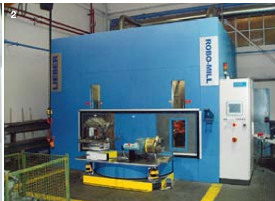
1 Unsere zweite CNC-Portalfräsmaschine FZ30 während der Inbetriebnahme. 2 Trenn- und Verputzautomat Robo-Mill der Firma LIEBER GmbH. 3 Industrieroboter mit Trennscheibe und Hochfrequenzfrässpindel im Inneren der Sicherheits- und Schallschutzumhausung.
