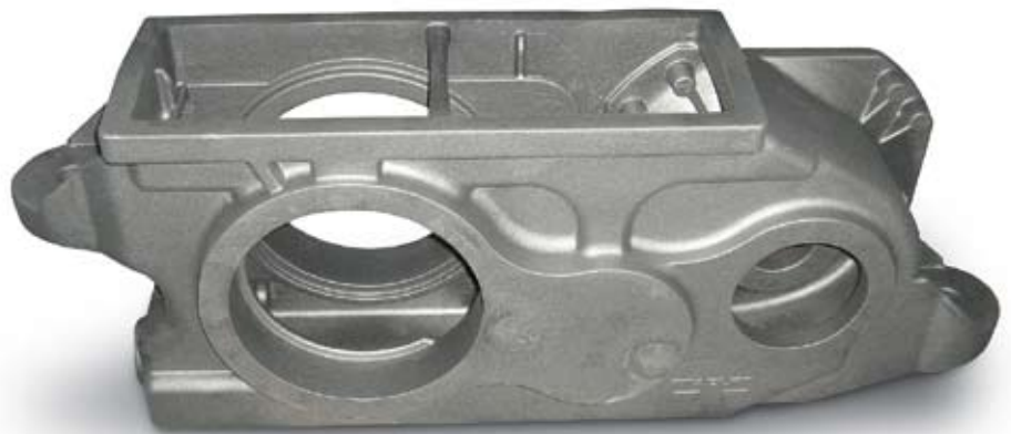
1 Elektrischer Doppelstocktriebzug DOSTO von Stadler Rail. 2 Achsantriebsgehäuse inkl. Motor, Zahnräder und Kupplung. 3 Deformation des Achsantriebsgehäuses unter Last. 4 Darstellung der Wärmezentren. 5 Rohgussteil nach dem Strahlen.
