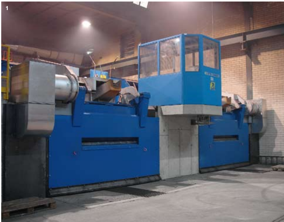
1 Der Tandem-Schmelzofen der Firma Otto Junker GmbH mit einer Kapazität von je 8 Tonnen Flüssigeisen pro Stunde. 2 Lärmgedämmte und sehr stabile Chargierwagen bedienen den Ofen mit Rohmaterial. 3 Kontrollpanel mit allen relevanten Angaben zur prozesssicheren Steuerung der beiden Öfen.
