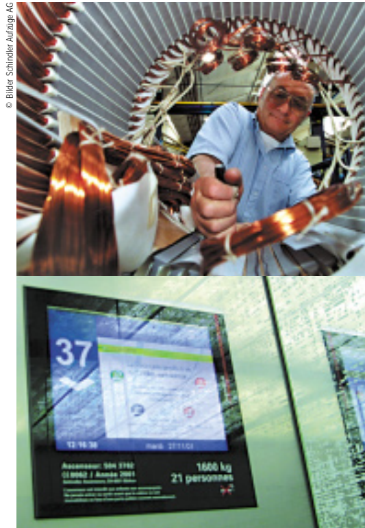
Montage in Ebikon von Hochleistungs-Antrieben für Aufzüge (oben). Das System Schindler E-Vision. Flachbildschirme mit Informationen zum Aufzug, zur Fahrt und zum Gebäude verkürzen die Fahrzeiten (unten). Montage d'entraînements haute performance pour ascenseurs à Ebikon (en haut). Le système E-Vision de Schindler. Des écrans plats renseignant sur l'ascenseur, le trajet et l'immeuble réduisent les temps de déplacement (en bas).
