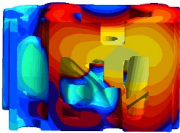
Bild 2: Darstellung des thermischen Moduls des Rohgussteils. Der grösste Modul liegt mitten im Gussteil.
