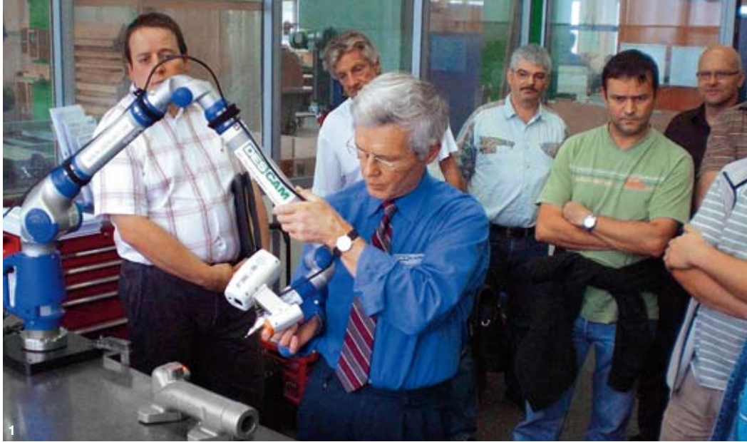
1 Ein moderner 3D-Laserscanner im Einsatz. Damit können ganze Geometrien vollflächig erfasst und für Massprotokolle oder die Erzeugung von CAD-Daten genutzt werden. 2 Interessierte Besucher lassen sich die Funktion eines 3D-Druckers erklären. 3 Die Kontaktpflege bei «Speis und Trank» darf nicht fehlen.
